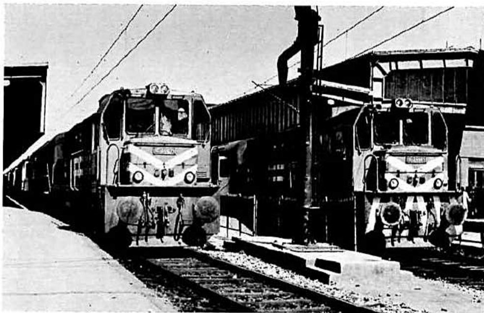
En la estación de Ankara el 4-8-77, dos locomotoras CC diesel-eléctricas de la serie 24 remolcando sendos expresos con destinos remotos: Bagdad, Damasco...
