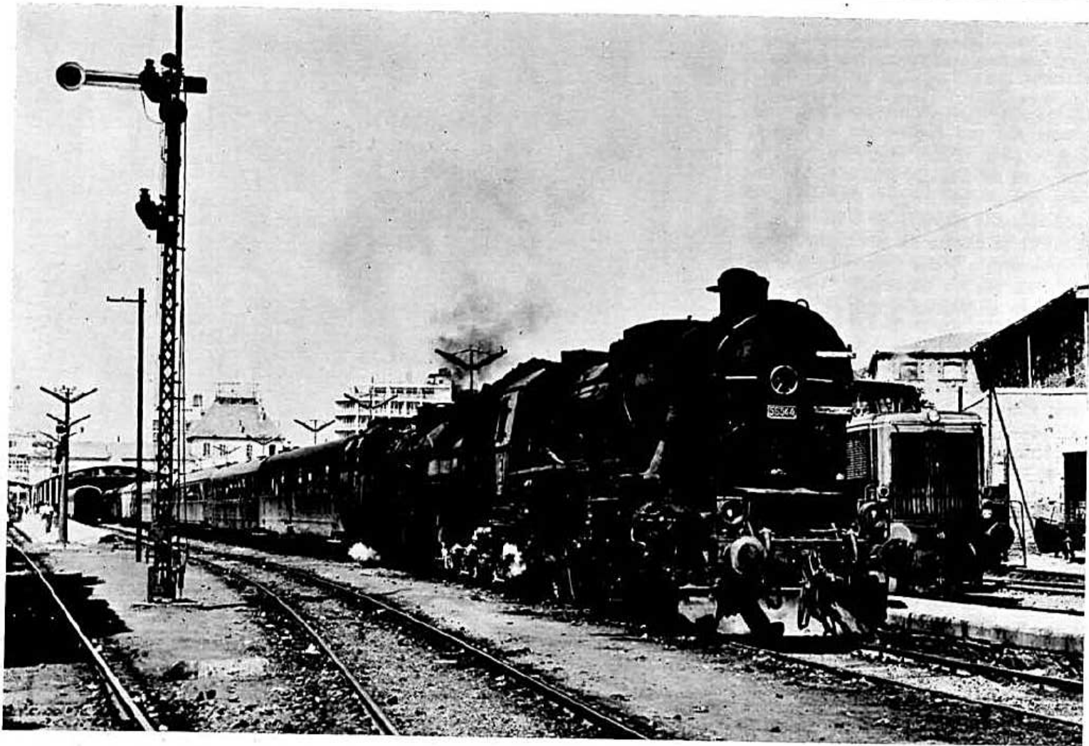
En medio de una decoración típicamente alemana, el expreso de Afyon remolcado por la 56544 1-5-0 «Kriegslok» tipo 52 de la DB y la 3705 2-3-2T tipo 78 de la DB, en la estación de Izmir Basmane el 12-8-77. Obsérvese al lado de la 1-5-0 uno de los tractores que hacen los trenes de cercanías.
