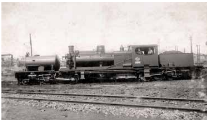
Una de les locomotores del tipus Garratt a l'estació de Manresa-Alta. ARXIU HISTÒRIC D'FGC (1931).
